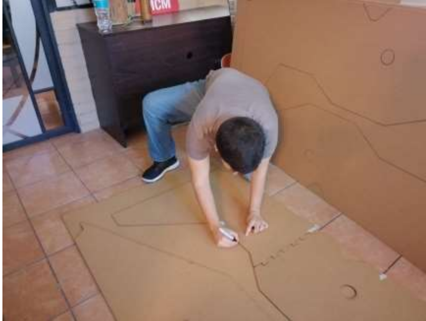
Ilustración 45. Calcando partes del vehículo de carrera sobre láminas de cartón
