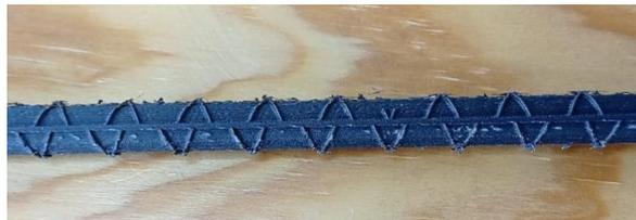
**Ilustración 23 - Varilla de fibra de carbono impresa con todas las corrugas.**
