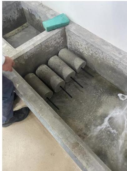
**Ilustración 22. Curado de Cilindros**
