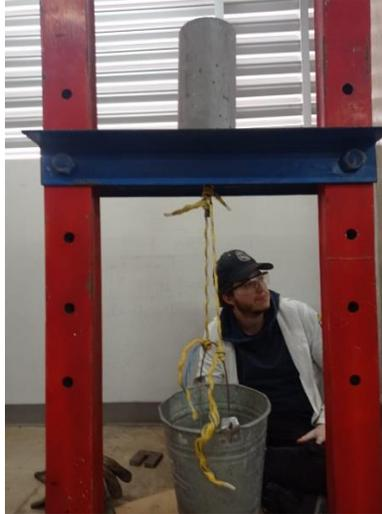
**Ilustración 31 - Sistema para prueba de adherencia**
