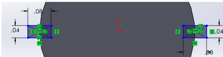
**Ilustración 18 - Dimensión de costillas de varilla en modelo SolidWorks.**
