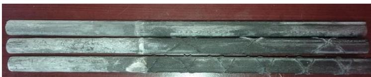
**Ilustración 35 - Varillas extraídas del ensayo de adherencia con pérdida de corrugas y parte de su estructura**
