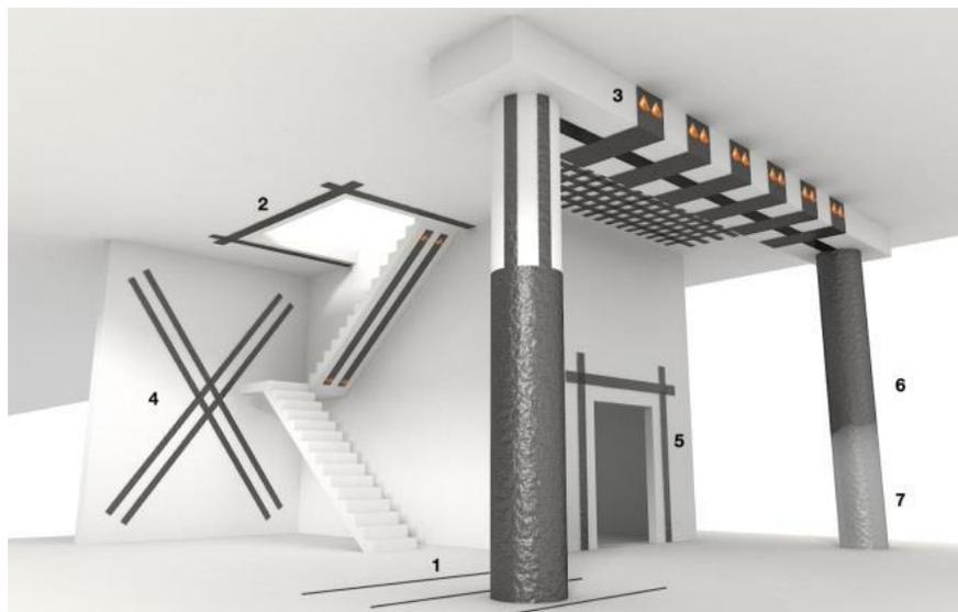
**Ilustración 8 - Ejemplo de polímero reforzado con fibra de carbono.**
