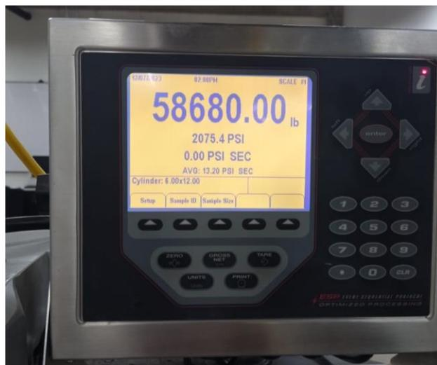
**Ilustración 29 - Lectura de carga compresiva aplicada a cilindro de concreto**
