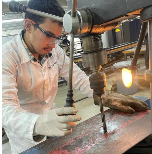
**Ilustración 28 - Perforación de viga de apoyo con broca de 5/8"**
