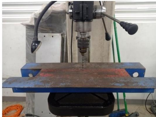
**Ilustración 27 - Perforación de viga de apoyo**
