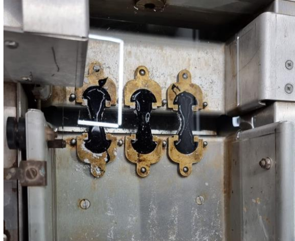
Ilustración 94. Briquetas de asfalto en el ductilómetro
