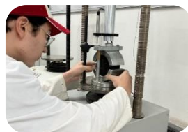
13: Colocar la probeta seca en la máquina estabilizadora Marshall
