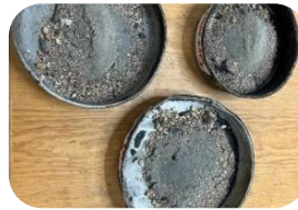
3: Colocar en una pana la cantidad de agregados definidos en el diseño
