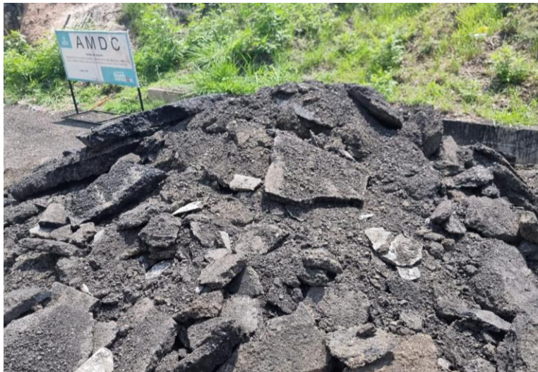
Ilustración 78. Residuo de carpeta asfáltica demolida (RAP1)
