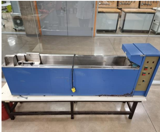
Ilustración 68. Máquina de prueba de ductilidad utilizada
