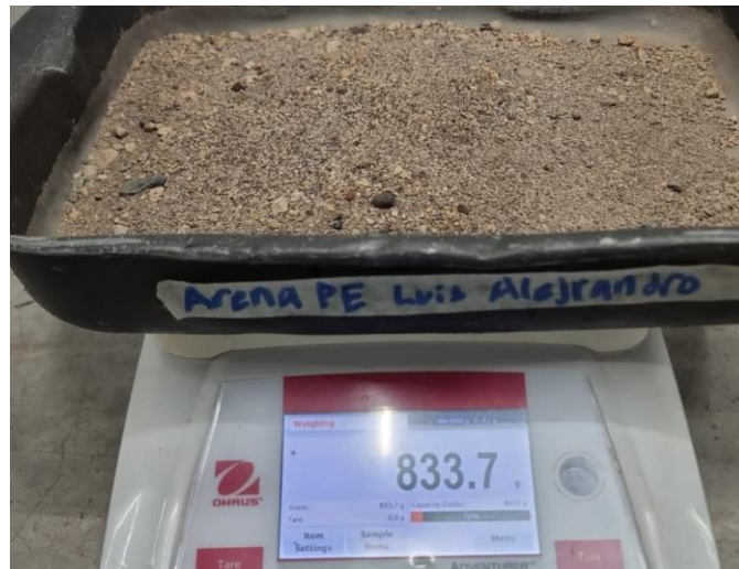
Ilustración 88. Peso de arena seca ensayo de peso específico
