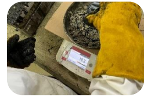
4: Añadir el asfalto a la mezcla y mezclar
