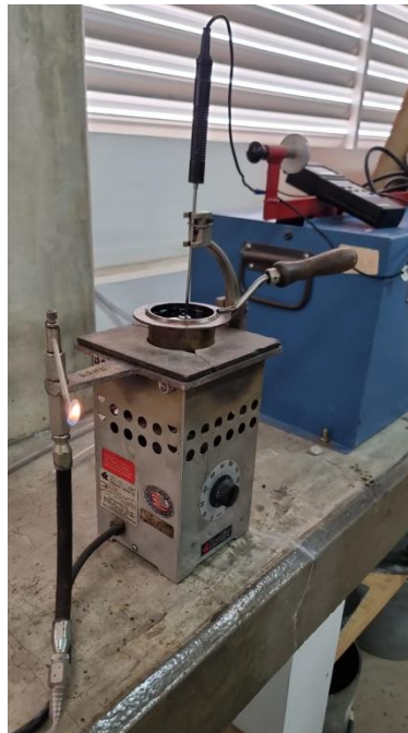
Ilustración 100. Equipo de Cleveland completo con termómetro
