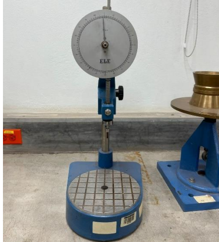
Ilustración 66. Penetrómetro del laboratorio de Ingeniería Civil
