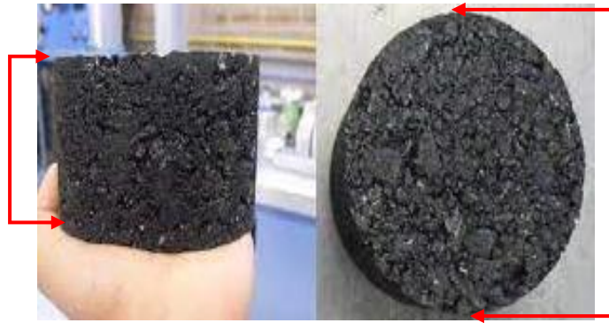
Ilustración 33. Altura y diámetro por medir de las probetas realizadas
