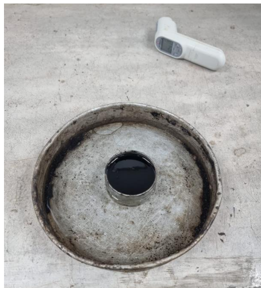
Ilustración 96. Cápsula de asfalto en agua
