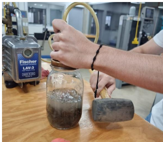
Ilustración 89. Extracción de aire del agregado grueso.
