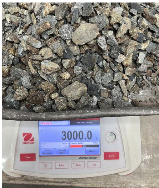
Ilustración 81. Muestra de 3000g del agregado grueso
