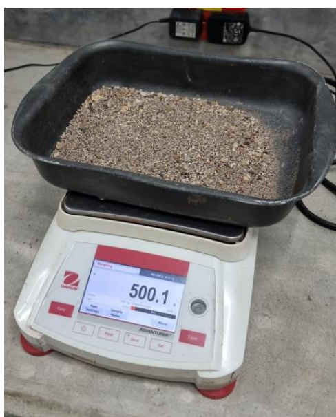
Ilustración 82. Muestra de 500g del agregado fino
