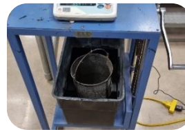
11: Registrar el peso al aire y sumergido de la probeta
