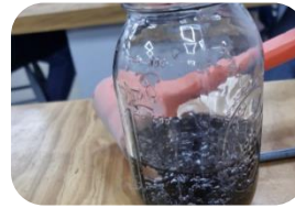
7: Realizar ensayo de gravedad específica a la mezcla suelta
