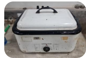
12: Sumergir la probeta por 30 minutos en agua a 60°C
