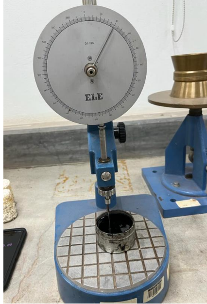
Ilustración 97. Ejemplo de ensayo de penetración
