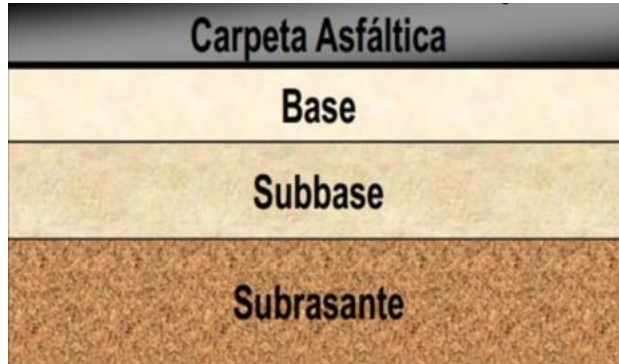
Ilustración 7. Capas de pavimento flexible
