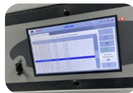
14: Registrar los datos de carga máxima y deformación en ese punto
