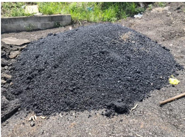
Ilustración 79. Residuo de carpeta asfáltica demolida (RAP2)
