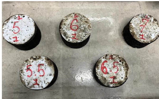
Ilustración 107. Probetas de concreto asfáltico reciclado RAP1
