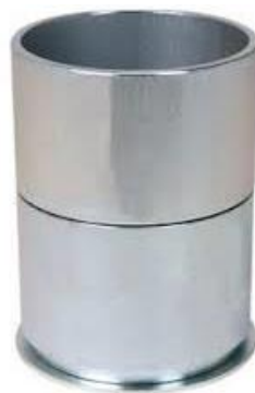
Ilustración 32. Molde de probetas de concreto asfáltico
