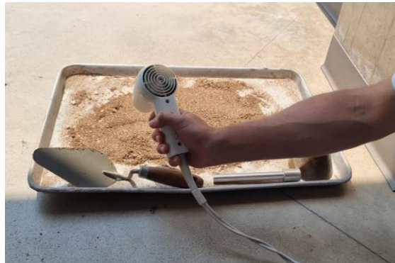
Ilustración 86. Secado de agregado fino
