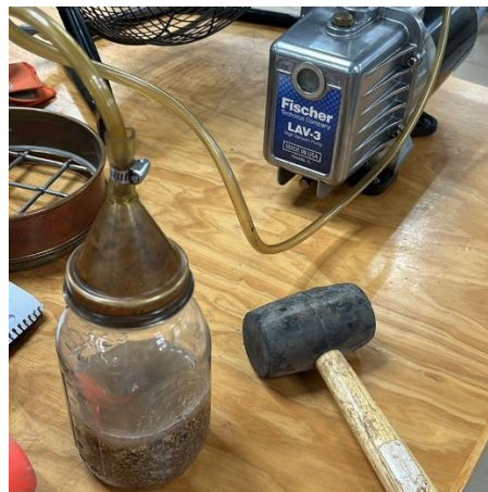
Ilustración 87. Extracción de aire del agregado fino
