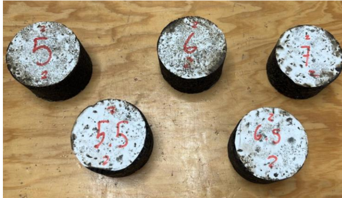
Ilustración 108. Probetas de concreto asfáltico reciclado RAP2
