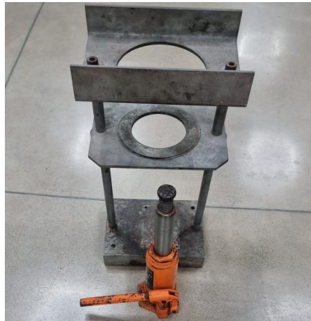
Ilustración 63. Extractor de especímenes Marshall utilizado
