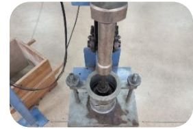
8: Compactar ambos lados de la probeta
