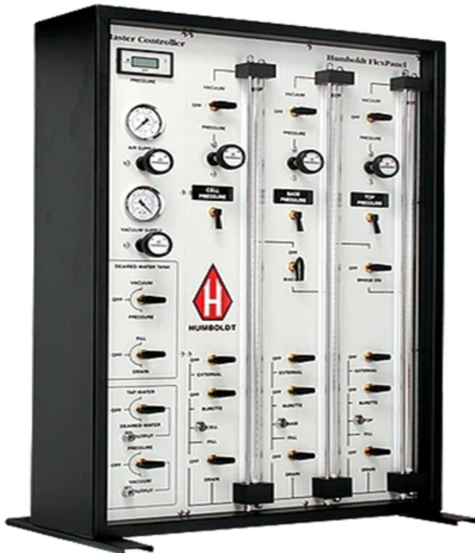
Este sistema de presión extremadamente versátil controla la presión, el agua, el tanque de desaireación y el vacío desde un solo panel.
