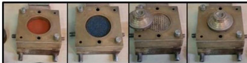
**Ilustración 8 - Montaje de la muestra en la caja de corte**
