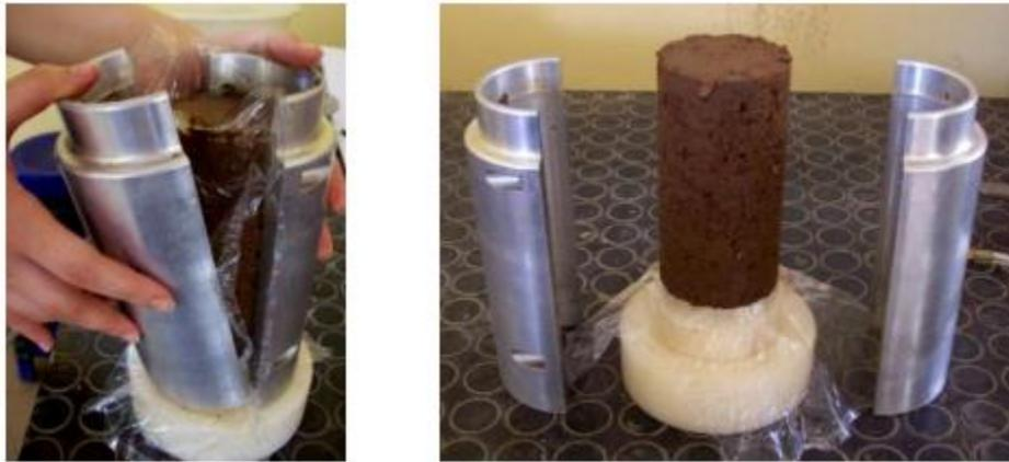
**Ilustración 7 – Extracción del espécimen del molde**
