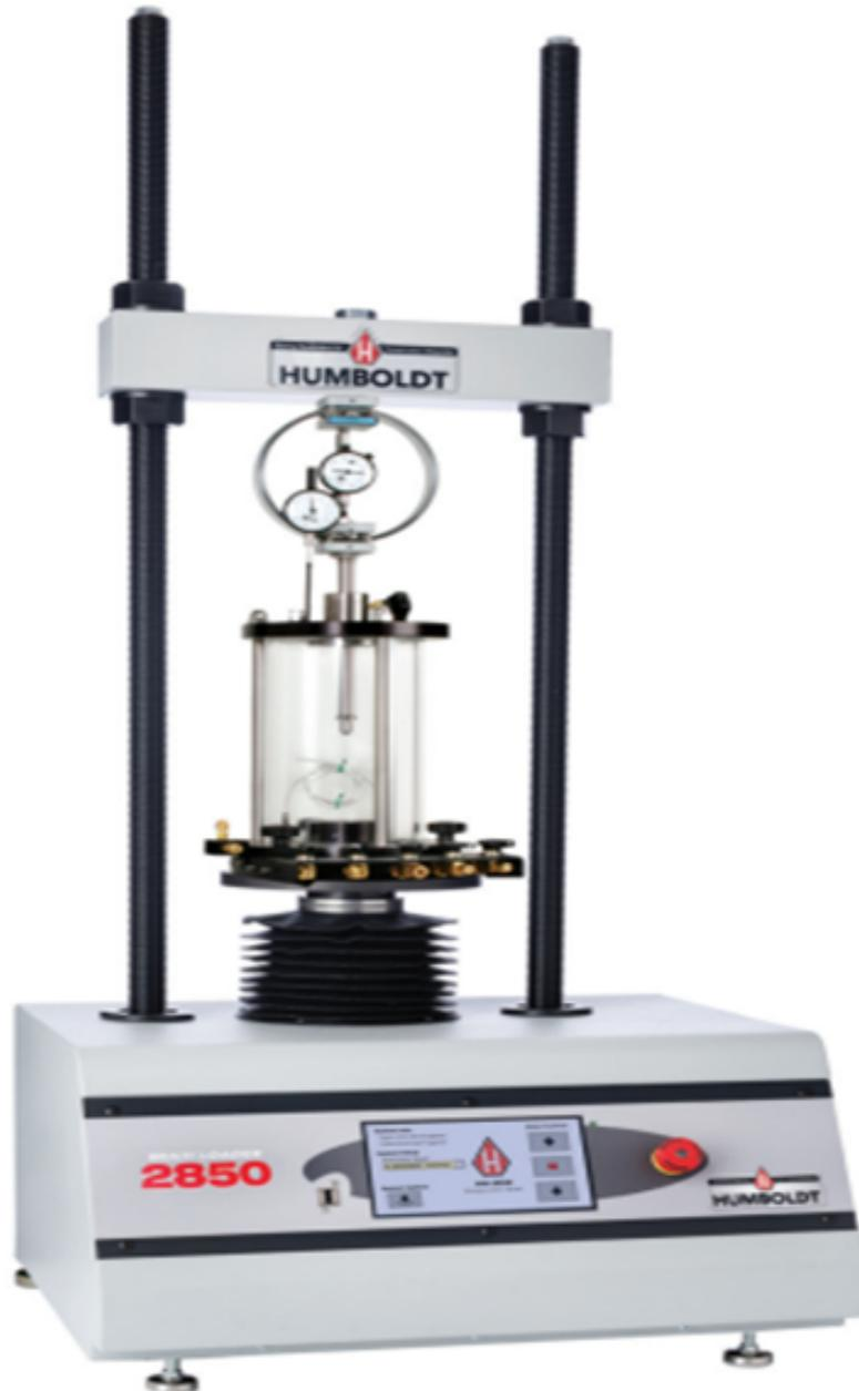
Una prensa de carga triaxial específico y de tamaño pequeño que proporciona la versatilidad, precisión y durabilidad que caracterizan a los marcos de carga.
