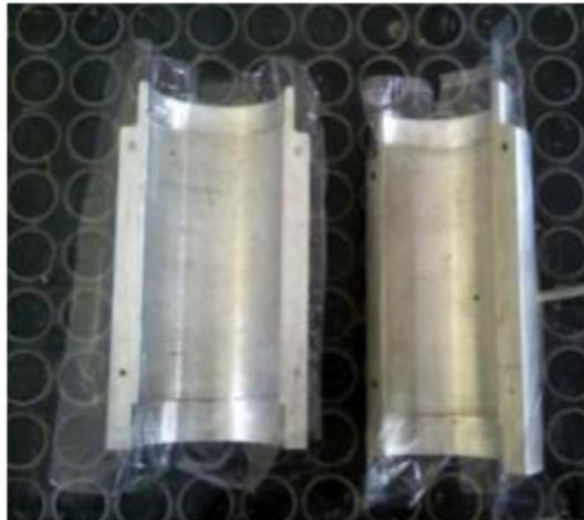
**Ilustración 4 – Colocación de láminas de plástico en el molde**
