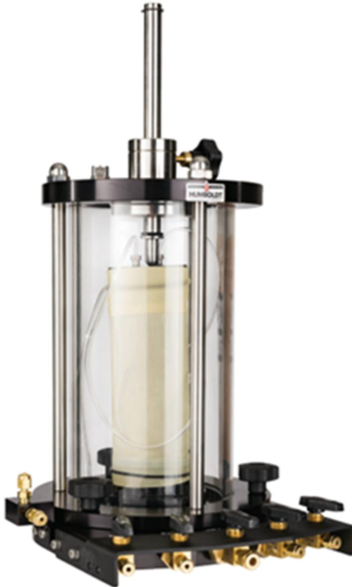
La celda ha sido diseñada y tratada para minimizar corrosión. Se ha prestado atención particular a la calidad del acabado entre el pistón y la cabeza.
