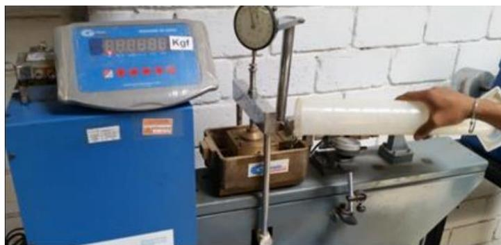
**Ilustración 11 - Inundación de caja de corte**
