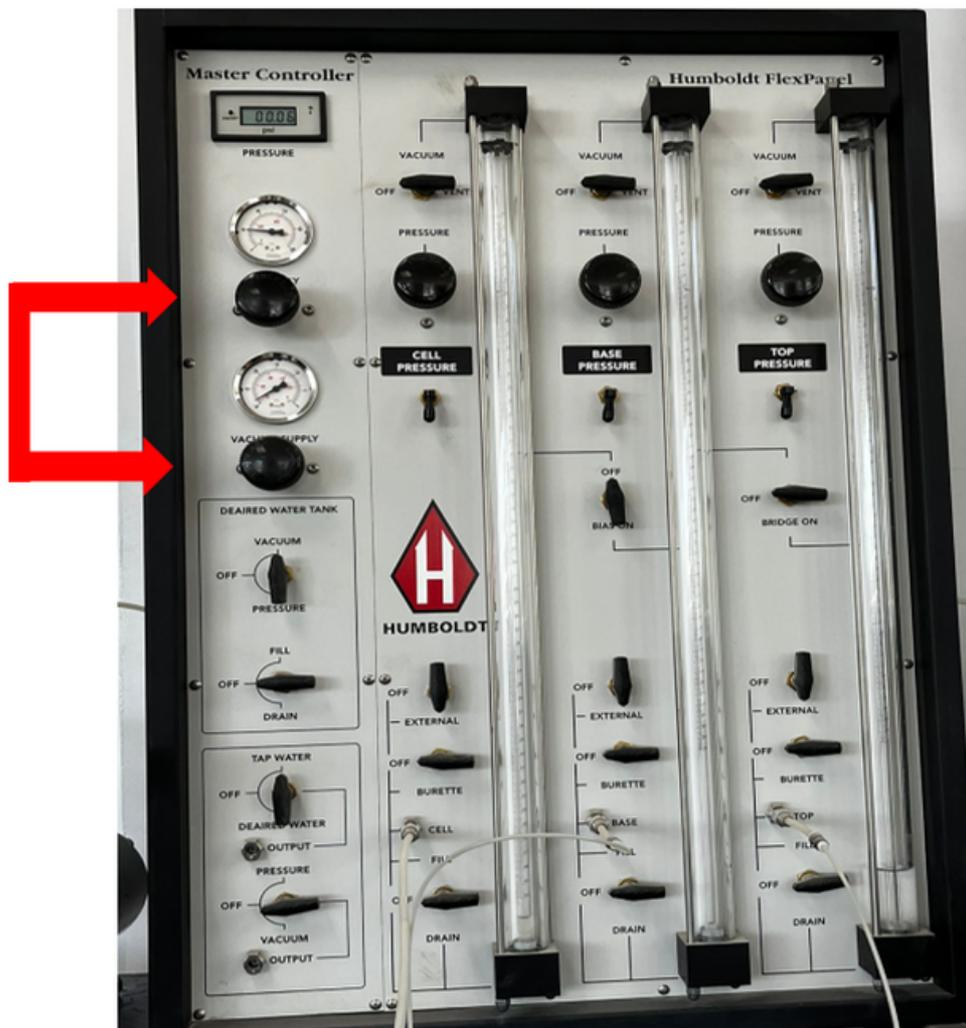
1. Pantalla Digital: Le permite leer la celda actual, presiones base o superior de hasta 5 celdas diferentes, dependiendo de su configuración particular. Para leer una presión, levante la válvula de palanca, ubicada debajo del regulador para el que desea comprobar la presión (indicado por el segundo rojo flecha) y la presión se mostrará en la pantalla digital. Solo se puede leer una línea a la vez.
