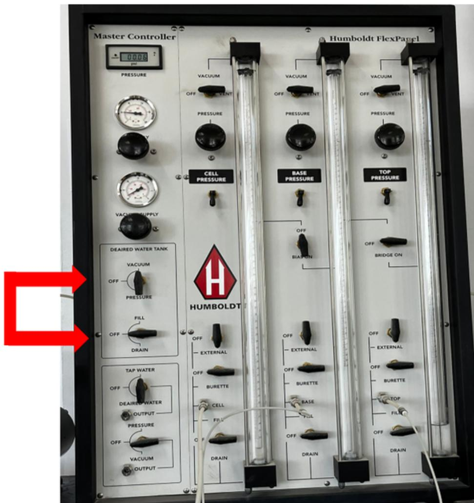
4. Esta sección controla las fuentes de agua, aire comprimido y vacío. La válvula superior se puede configurar para suministrar agua del grifo o agua desairada a la conexión rápida ubicada debajo de él. La válvula inferior suministra una presión de aire o vacío regulado a la conexión rápida debajo de él. La presión de aire es suministrada por el mismo regulador que suministra aire al tanque de agua desaireada y el vacío es regulado por el vacío regulador.
