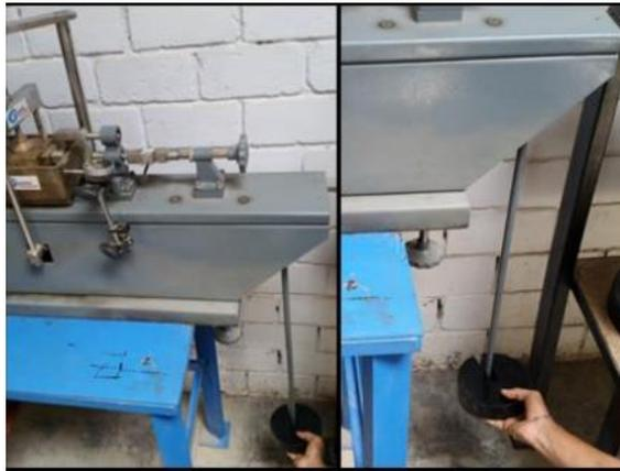
**Ilustración 10 - Aplicación de cargas normales**
