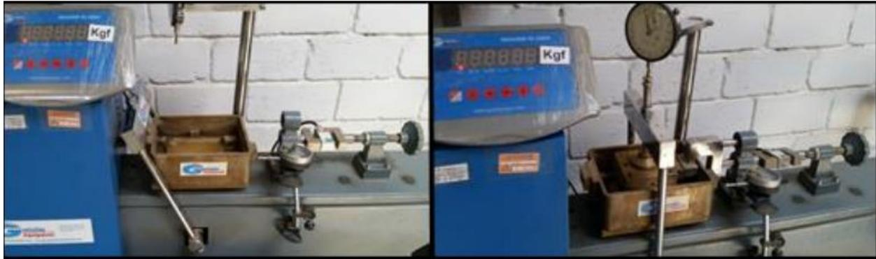
**Ilustración 9 - Ensamble de caja de en máquina de corte directo**
