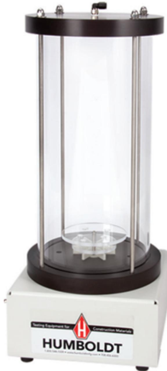
La combinación del agitador mecánico y la evacuación por vacío eliminan los gases a una razón mucho mayor que los métodos convencionales por ebullición.
