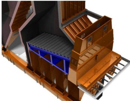
**Ilustración 9-Horno de combustible húmedo**
