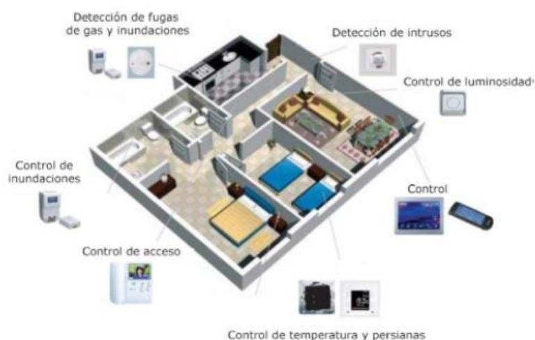
Figura 4.3 Distribución de un sistema domótico en una vivienda
