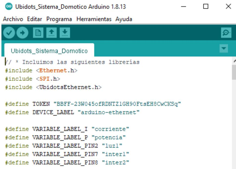
Figura 8.30 Asignación de variables en IDE de Arduino
