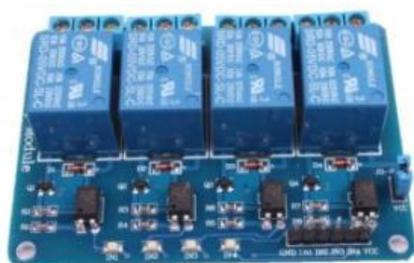
Figura 4.12 Módulo de relé de 4 canales
