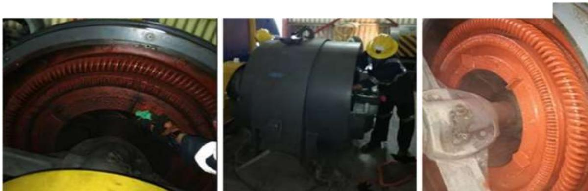
Ilustración 18: Mantenimiento al motor de malacate del sapote.
