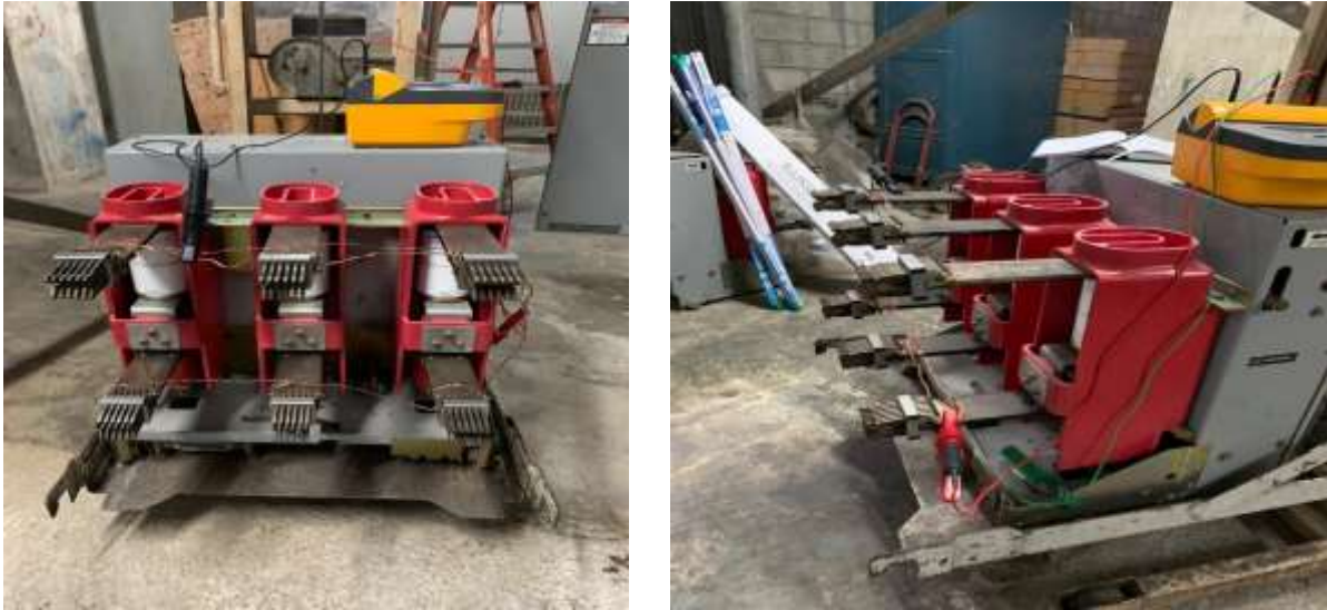
Ilustración 13. medición en serie con tierra y medición contra polos
